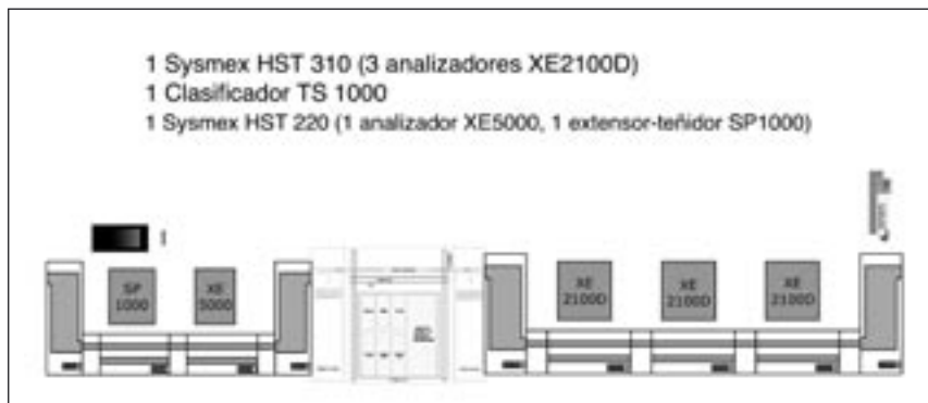
Figura 2. Automatización del laboratorio de hematología-core. Sistema modular Sysmex HST.
